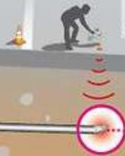
**4** Am Ziel angekommen werden die Kabel am Bohrkopf befestigt und zurückgezogen
